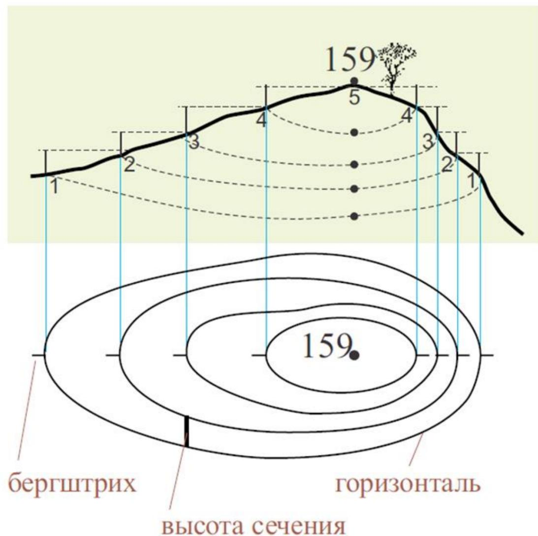
**Горизонталы (изогипсы)** – линии на карте, вдоль которых все точки земной поверхности имеют одинаковую абсолютную высоту. Они помогают определять крутизну склонов.
